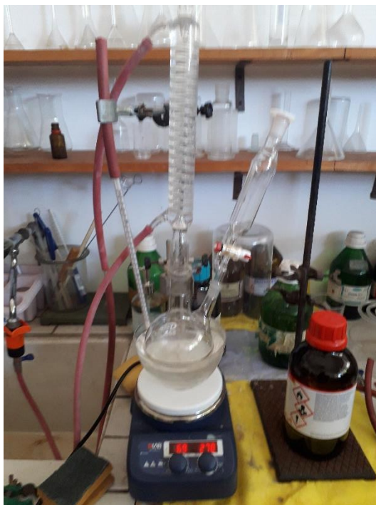
Slika 59. Aparatura za sintezu tiokarbhidrazida
