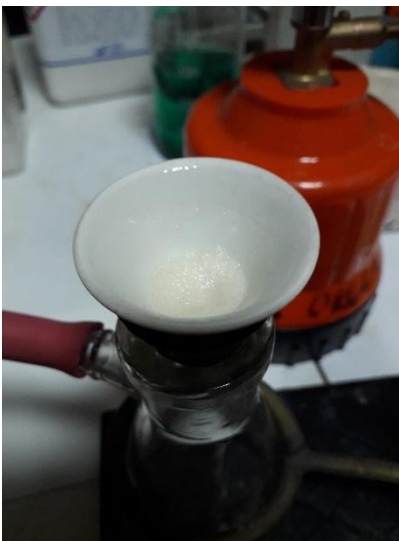
Slika 64. Cijedenje u vakuumu
