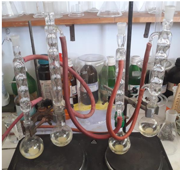
Slika 62. Aparatura za dobijanje Schiff-ovih baza
