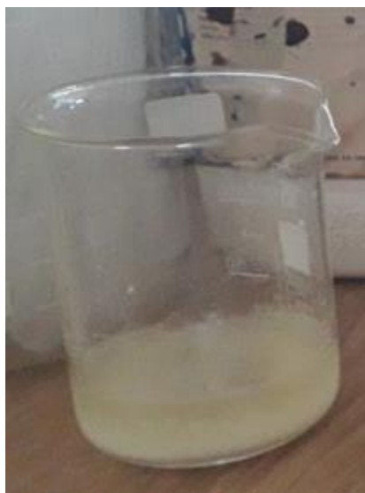
Slika 66. Rastvor sintetisane Schiff-ove baze nakon prvih par minuta hlađenja
